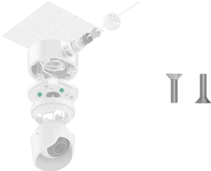
3. Установіть корпус камери в тримач так, щоб об'єктив камери був спрямований на зону під охороною. Закрутіть два гвинти в тримачі за допомогою комплектного шестигранного ключа ( $\varnothing$  2 мм).
