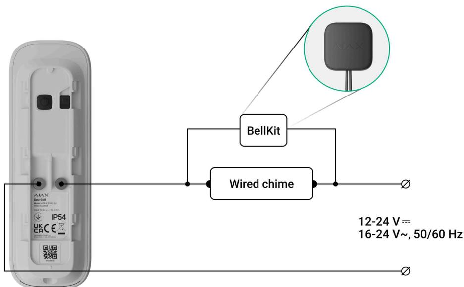
Після під'єднання DoorBell і BellKit до дротового дзвінка потрібно налаштувати під'єднання до дзвінка в застосунку Ajax. Перед налаштуванням переконайтеся, що DoorBell додано в систему.
