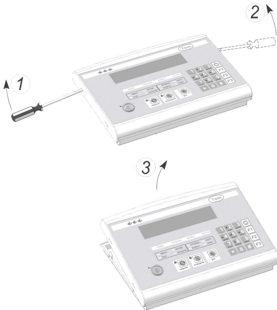
Рисунок 7.7 - Порядок відкривання корпусу приладу
